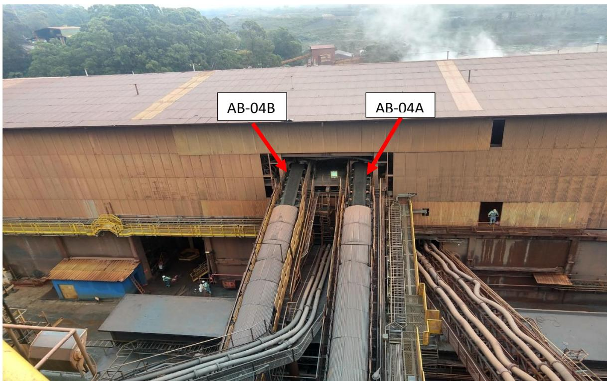
*Figura 1: Transportadores AB-04A / AB-04B que são responsáveis pela entrada de minério para a Usina de Concentração*
