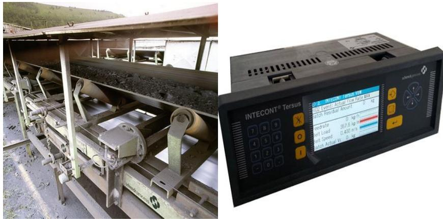
Figura 7: Balança integradora instalada no transportador e módulo de pesagem
