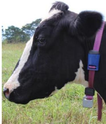
**Figura 9. Coleira eletrônica C-Tech com acelerômetro embutido**
