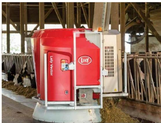
**Figura 4. Sistema de alimentação automática Vector**
