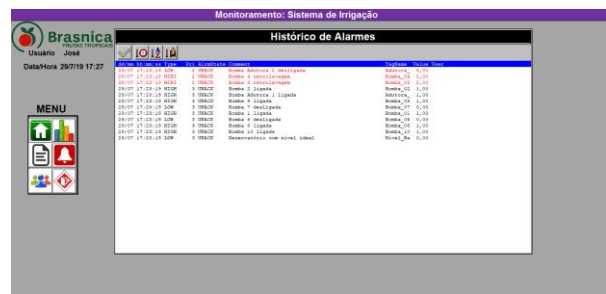
Figura 8 – Tela de alarmes do sistema supervisório.
