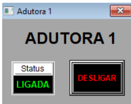
Figura 16 – Tela pop-up utilizada para ligar ou desligar as bombas adutoras.
