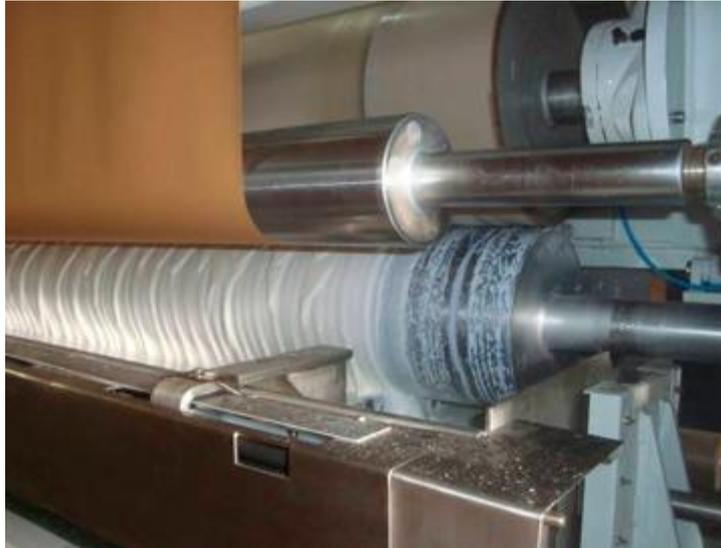
Figura 2: Detalhe de passagem de papel entre rolos coletor e dosador.
