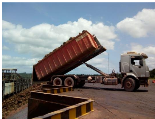
Figura 2: Caminhão roll on/roll off descarregando em moega
