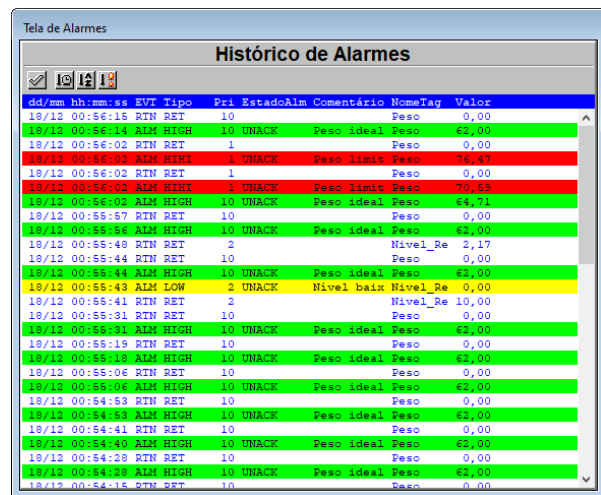
Figura 7 – Tela de alarmes do sistema supervisão.
