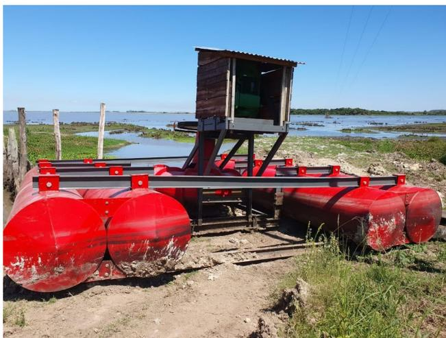
Figura 1 – Estação de bombeamento
